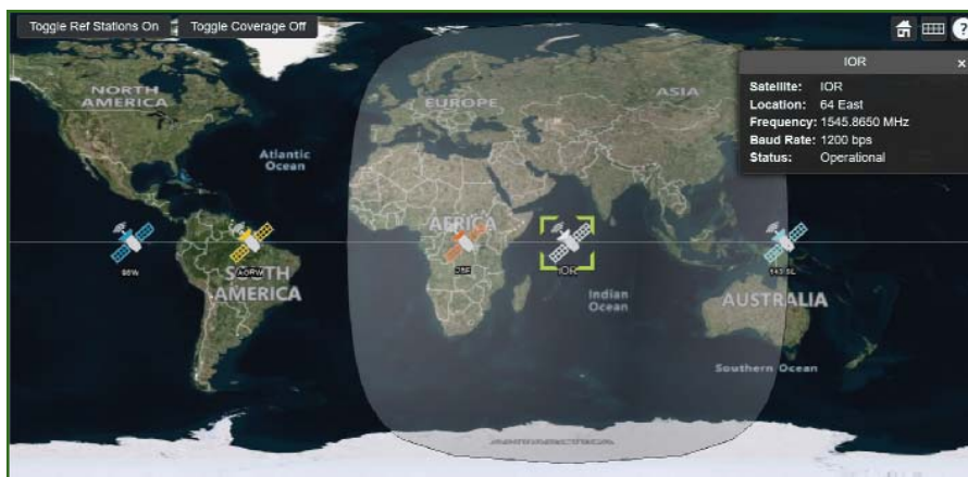
Рис. 1 Зона передачи поправок с одного из геостационарных спутников TerraStar ( https://terrastar.net/services/terrastar-coverage-map )
